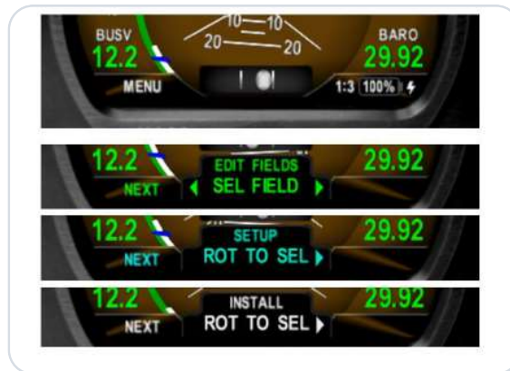
Figure 2 · Ordre des champs dans le menu d'installation
