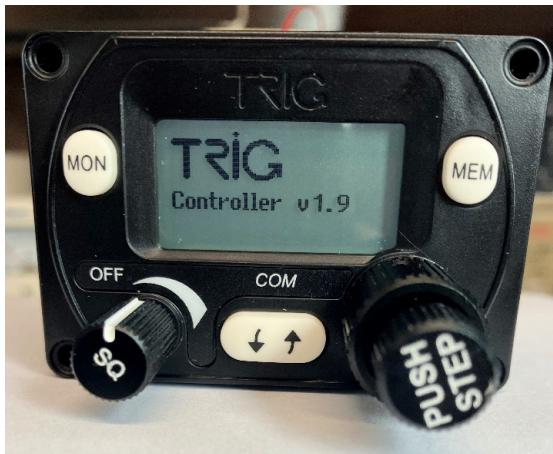
La versión actual del firmware aparece brevemente después del encendido. Debería mostrar al menos "Controller v 1.5".
