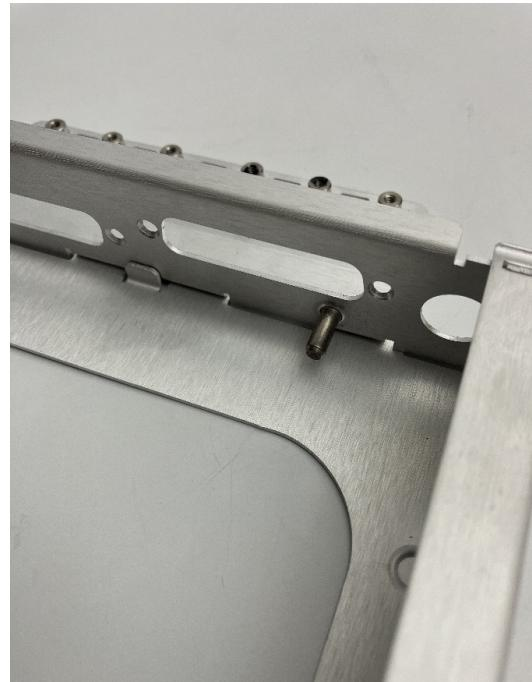
1. Retirez les deux vis cruciformes pour détacher le connecteur TRIG du support de la radio.
