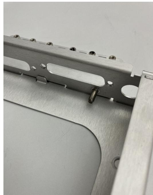
1. Retire los dos tornillos Phillips para separar el conector TRIG de la bandeja de la radio.
