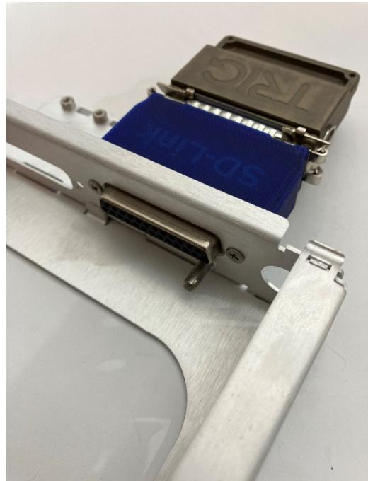
5. Conecte el adaptador SD-TY96-DS al conector TRIG uniendo las grapas del adaptador con las grapas de sujeción instaladas del conector TRIG.
