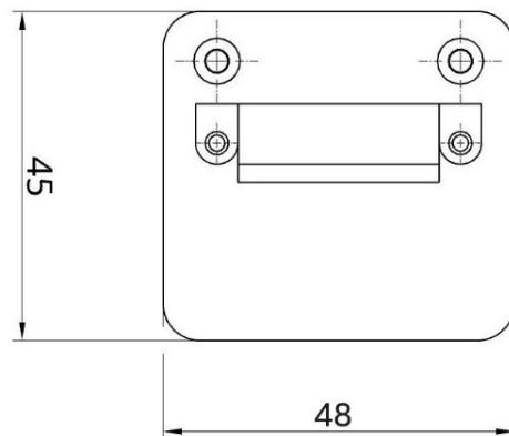
Bluetooth Low Energy Adapter (BLE) für einen TRIG TY91/92 VHF-Transceiver (Flugfunk Radio). Der Adapter wurde als Interface eines TRIG TY91/92 zur Navigationssoftware Skydemon (SD) entwickelt. Er realisiert die Umsetzung der Datentransfers zwischen der Navigationssoftware (SD) und der Hardware des Bedienteils TC90 des Funkgerätes (BLE <-> RS-232). Der Adapter wird einfach zwischen die existierende Verkabelung zum Bedienteil TC90 gesteckt und hält dank zweier Rändelschrauben selbst am Gehäuse.
