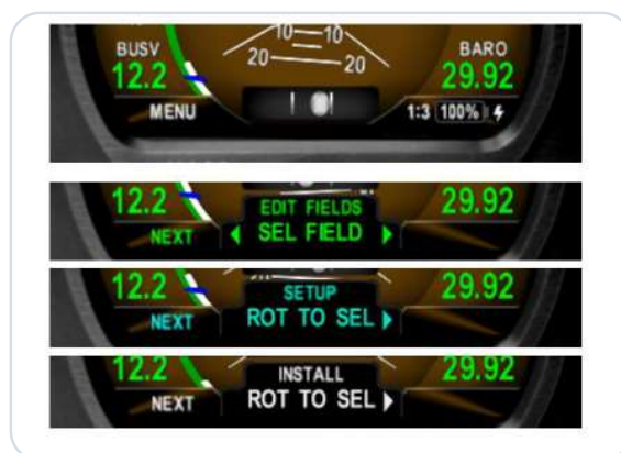
Figur 2 · Rekkefølge på feltene i installasjonsmenyen
